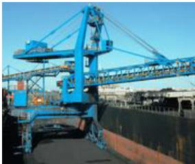
Hình 4 Máy chất tải di chuyển, năng suất chất tải 3000 t/h, được sử dụng ở Cảng Mozambique
