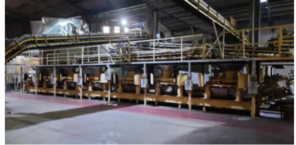
Hình 4. Công đoạn vò chè được tự động hóa 100%
