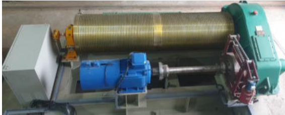
Hình 1. Cơ cấu nâng đang được chế tạo tại xưởng.
