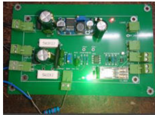
Hình 6. Kết quả thử nghiệm khi điện trở cách điện R_{cd} < 22k\Omega
