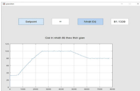
Hình 8. Kết quả chạy thử tại điểm đặt 80°C
